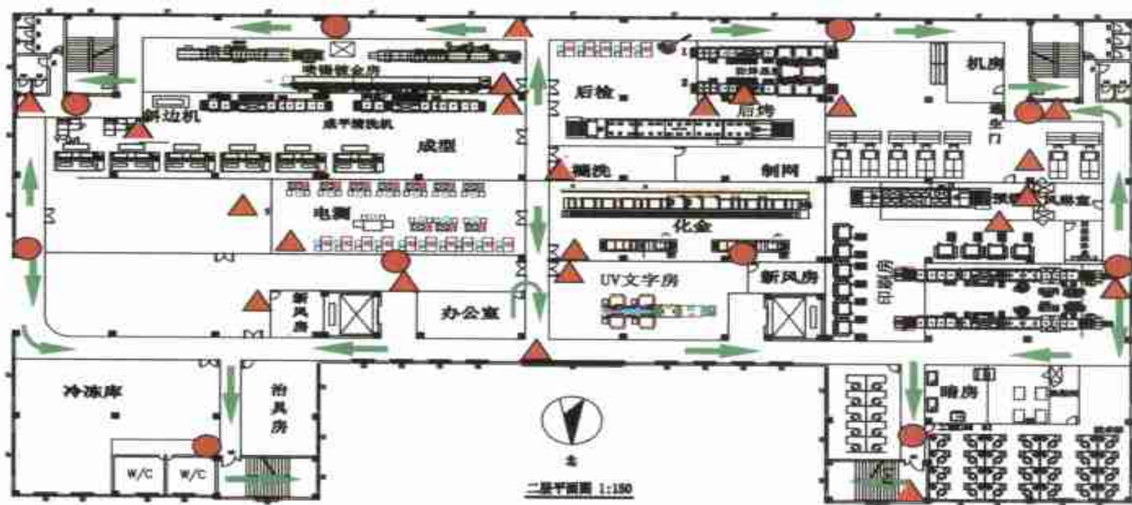
逃生路线及消防栓、灭火器布局图
