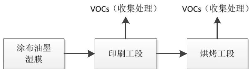
图 3-7 内层工序 VOCs 产生及排放示意图
